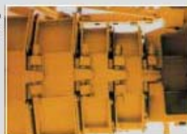
Sistema de alinhamento das seções da lança telescópica
