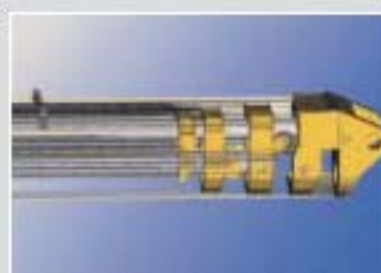
Pontos de lubrificação laterais para cada seção da lança
